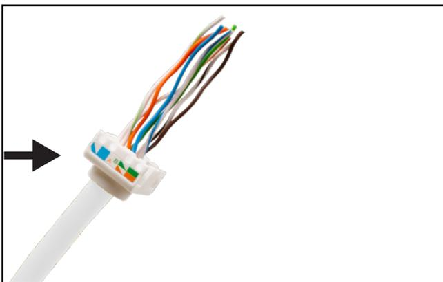
Haal de UTP-kabel door het kapje met kleuraanwijzingen heen.
