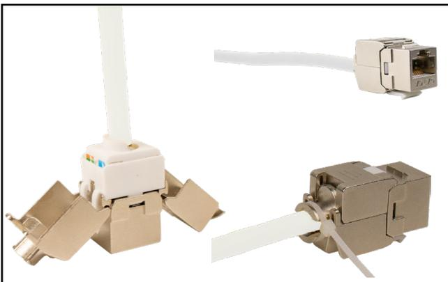
De UTP netwerkkabel is nu gemonteerd. Plaats het kapje dat verbonden is met de UTP netwerkkabel op de keystone en druk stevig aan. Het kapje past maar op 1 manier op de keystone.
